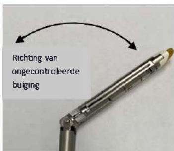
Afbeelding 1: Richting van ongecontroleerde buiging
