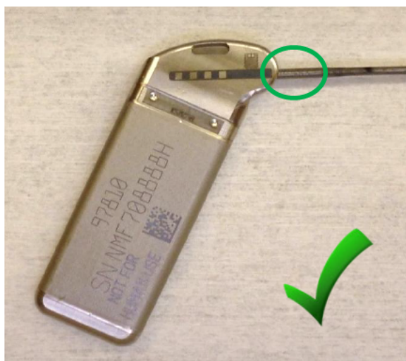
Afbeelding 2a - Compatibel oplaadbaar systeem Er zijn geen blauwe markeringsringetjes zichtbaar indien volledig in de INS-connector geplaatst
