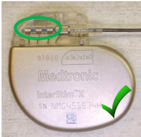
Afbeelding 1a - Compatibel niet-oplaadbaar systeem Er zijn blauwe markeringsringetjes zichtbaar tussen de contactpunten in de INS-connector
