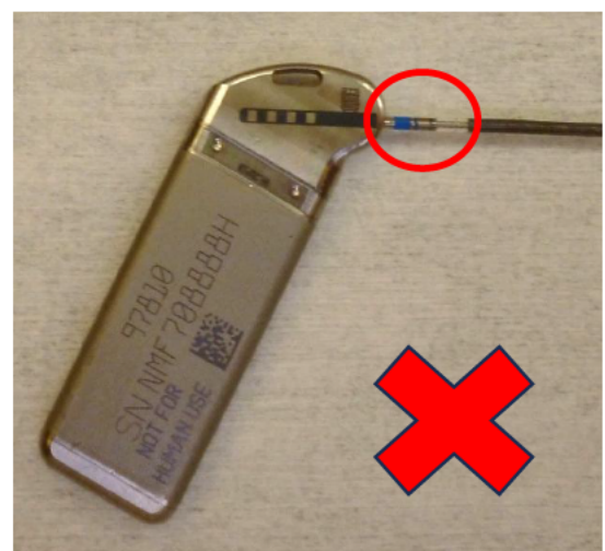
Afbeelding 2b - Incompatibele geleidingsdraad en INS Er zijn nog steeds blauwe markeringsringetjes zichtbaar buiten de INS-connector indien niet volledig geplaatst
