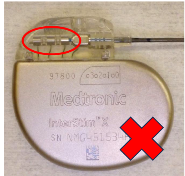
Afbeelding 1b - Incompatibele geleidingsdraad en INS Er zijn geen blauwe markeringsringetjes zichtbaar tussen de contactpunten in de INS-connector
