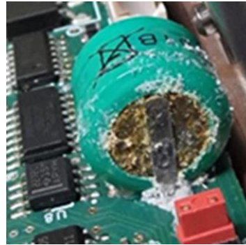
Figuur 1: Afbeelding van gecorrodeerde BT1 geïntegreerde batterij
