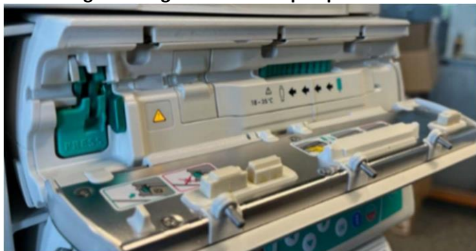
Afbeelding 3 - Correcte toestand: de bedieningshendel blijft vergrendeld en houdt de veiligheidsklem open
