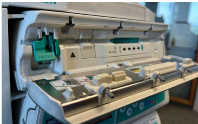
Afbeelding 1 - Veiligheidsklem in gesloten positie na het openen van de pompdeur
