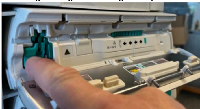
Afbeelding 2 - Veiligheidsklem in open positie wanneer de bedieningshendel wordt ingedrukt
