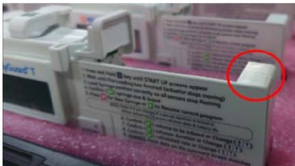
Afbeelding1 & 2: Voorbeeld van een scheur in de voorste behuizing van een BD Bodyguard™ T-spuitpomp
