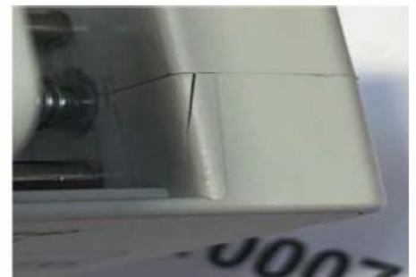
Afbeelding1 & 2: Voorbeeld van een scheur in de voorste behuizing van een BD Bodyguard™ T-spuitpomp
