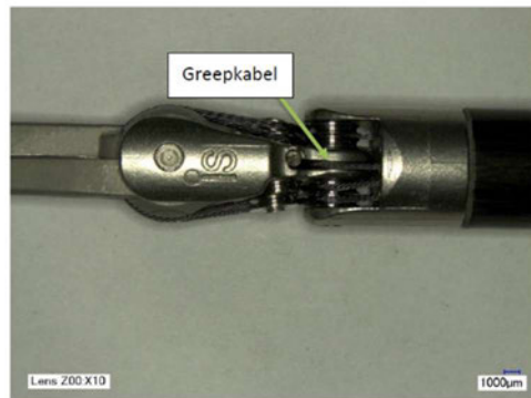
Afbeelding A: een voorbeeld van een onbeschadigde gripkabel, 10x uitvergroot, op een da Vinci Xi Tenaculum-tang.
