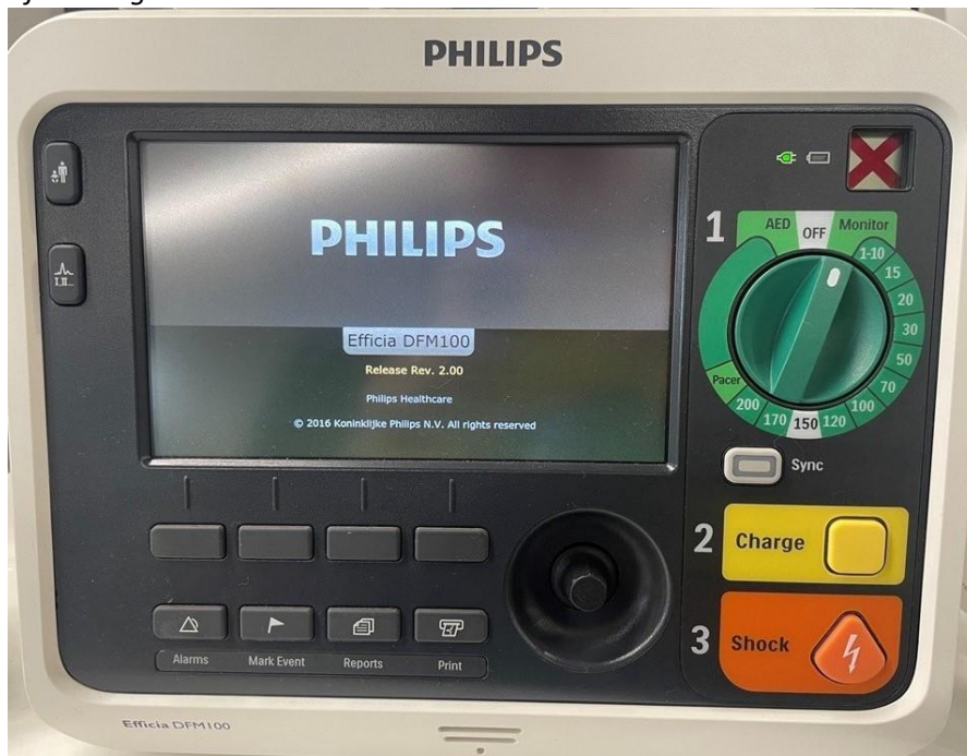
Afbeelding 1: Voorbeeld DFM100-welkomstscherm met een rode "X" in RFU-indicator
