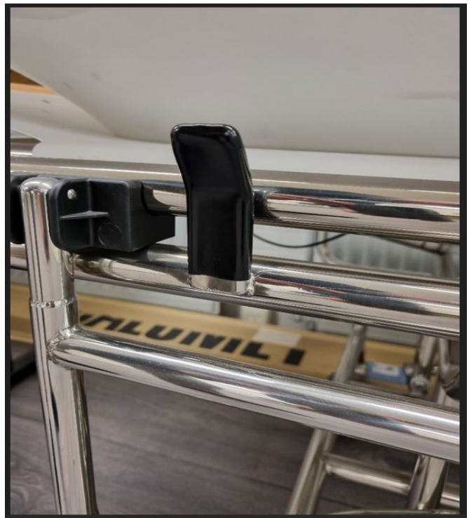
Afbeelding 2: Haak met correct gemonteerde beschermkap
