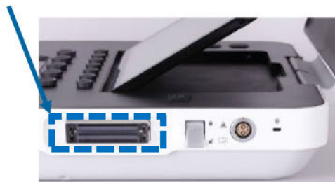
Afbeelding 3. Poort aan de zijkant voor een rechtstreeks aangesloten transducer
