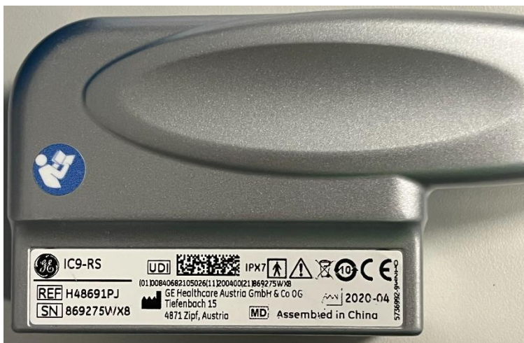
Afbeelding 4. Voorbeeld typeplaatje – met weergave van het type taster (IC9-RS) en serienummer (SN).
