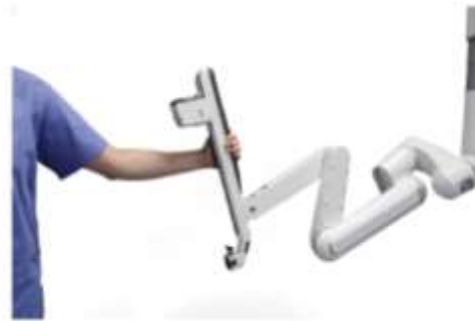
Figuur 2: Afbeelding die laat zien hoe de USM tijdens handmatig positioneren vast te houden
