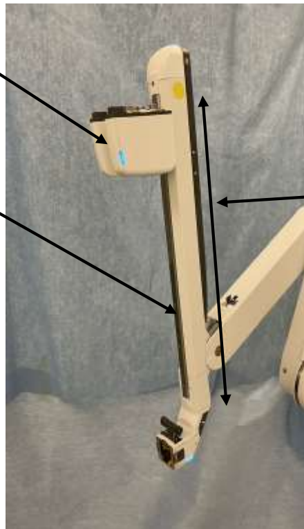
Figuur 1: instrumentdrager en inbrengasrail op instrumentarm
