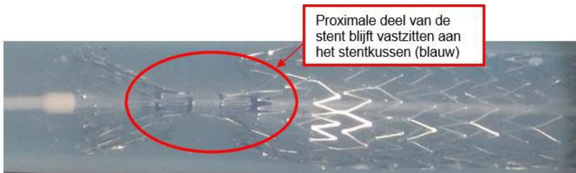
Afbeelding 1: Het proximale uiteinde van de stent blijft verbonden met het stentkussenmateriaal.
