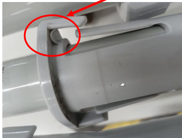
Figuur 1: zijhekconnector met braam
