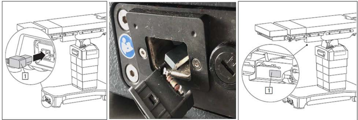
Figuur 1: Plaats van de netvoedingsaansluiting op de OK-tafel / uitgetrokken netvoedingsaansluiting met blootliggende elektronische componenten / positie van het productlabel op de mobiele OK-tafel MEERA inclusief SN
